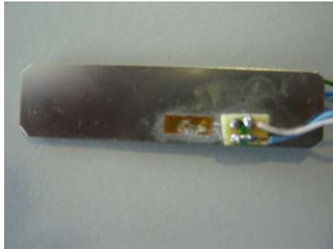
Fig. 2.15 - Dois sensores aplicado numa capa de aço deformável.
