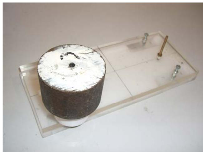
Fig. 2.10 - Teste do extensómetro
