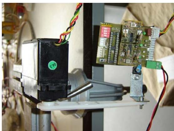
Fig. 3.9 - Teste dos acelerómetros (posição vertical  $+1g$  ou  $-90^\circ$ )
